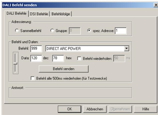
Wechseln Sie dann auf den Button "erw. Einstellungen" bzw. "DALI Commands". Sie erhalten hier eine Eingabemöglichkeit für individuelle DALI Befehle. Gezeigt ist hier die Eingabe eines "Direct Arc Power" Befehls für die "spezielle Adresse" 1. Bitte beachten Sie, dass die Nomenklatur für die Programmierung stets bei Null beginnt - "0" meint also Kanal oder Gerät Nr. 1, während "1" demzufolge Gerät oder DMX Kanal Nr. 2 bezeichnet.
